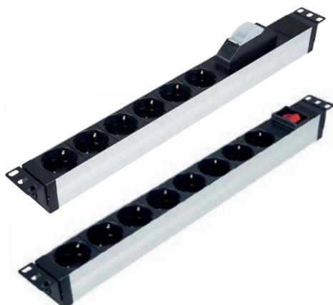
19" 1U Блок розеток Schuko DIN49440 на 6 позиций, алюминиевый профиль, 1x16A автоматический выключатель, 4000 W, 250V AC, 3x1.5мм<sup>2</sup>, шнур 2,5м с вилкой Schuko DIN49440.
