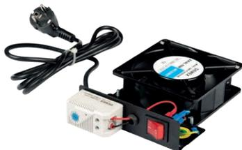
Экономичные бескорпусные вентиляционные модули для настенных шкафов, поставляются с ручным выключателем или аналоговым термостатом. Расход воздуха отдельного вентилятора 2,3-3 куб.м/мин. Технические характеристики : 18/17 Вт, 220/240 В, 50/60 гЦ, 0,13/0,11 А, 2300/3000 об/мин, уровень шума 42 дБ, время службы: 50000 часов.
