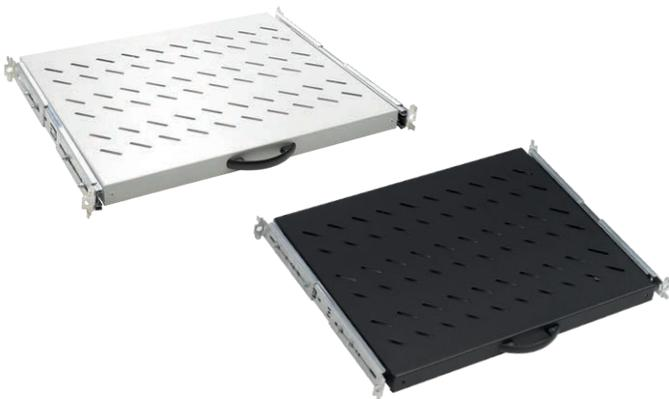
Стальные перфорированные выдвижные полки для закрепления в 4 точках на 2 пары монтажных направляющих. Совместимы со шкафами любых производителей. Регулируются по глубине установки. Изготавливаются в цветах: светло-серый RAL 7035, черный RAL 9005. Максимальная нагрузка 50 кг.
